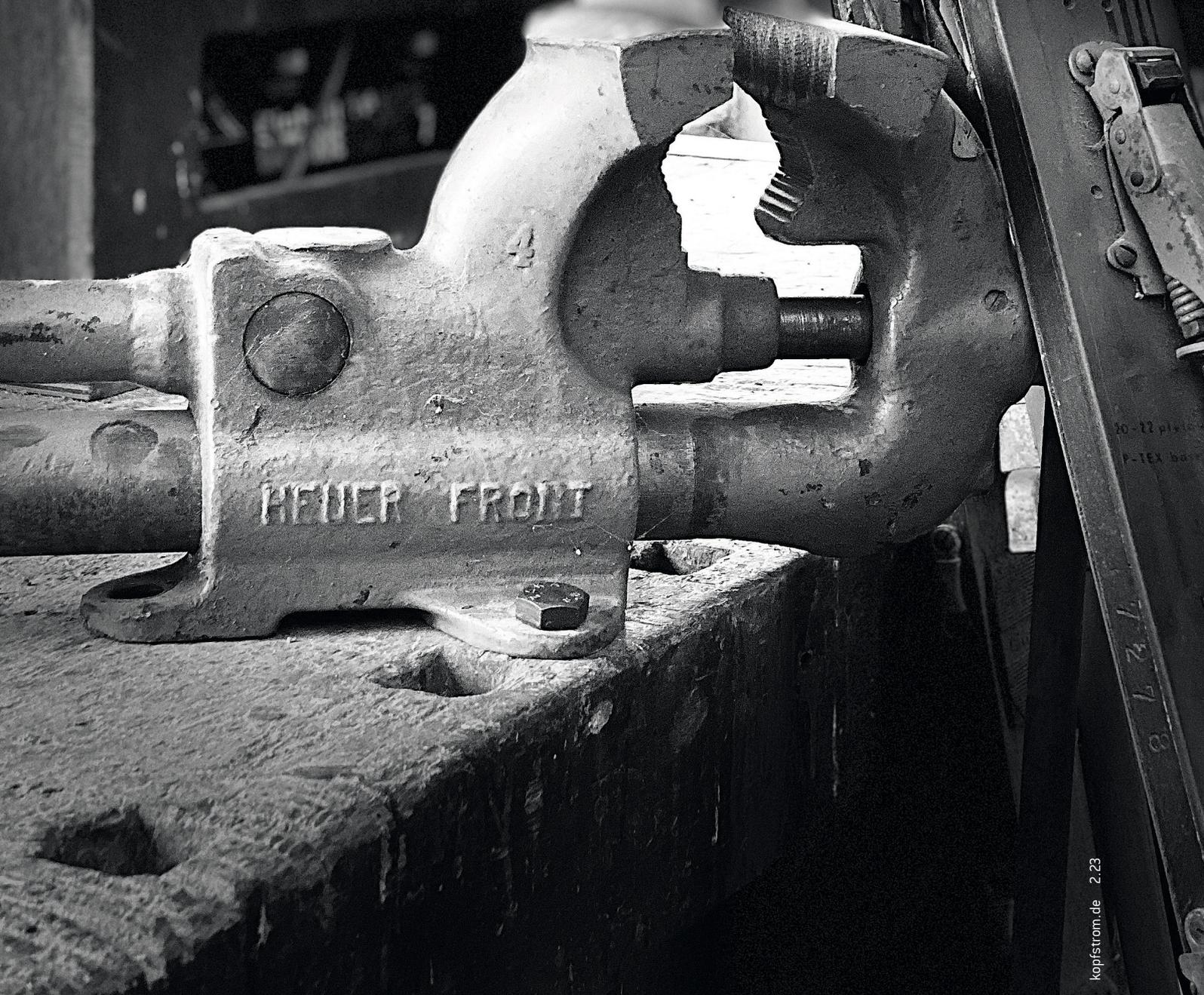
Unsere Schraubstücke sind Made in Germany. Sie sind ganz aus Stahl geschmiedet, präzise, unzerbrechlich, mit zentrisch nachstellbarer Führung, innenliegender Prismenführung und halten länger, als eine Generation – das ist Nachhaltigkeit.
