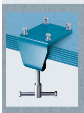
HEUER工作台卡紧装置只需几个简单的步骤,即可轻松快速地组装和拆卸.强大的夹紧主轴及成熟的HEUER支撑扳手可以确保方便和安全的操作.四个螺丝座与HEUER台虎钳100或120匹配.
