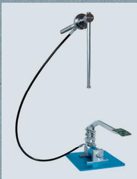
Mit dem HEUER Kurzhub-Modul lässt sich ein vorhandener Schraubstock in kurzer Zeit in einen wahren „Schnellspanner“ umrüsten. Alle für das Aufrüsten notwendigen Teile werden im Set mitgeliefert.
